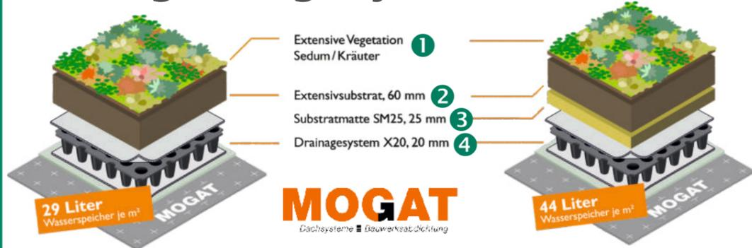
Abb. links: System **GS DURA Basis** mit Wasser-Speicherkapazität von 29 Litern / m<sup>2</sup> und einem Gewicht von 87 kg / m<sup>2</sup> im gesättigten Zustand
